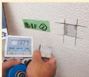
GNSフィラー付着力試験
